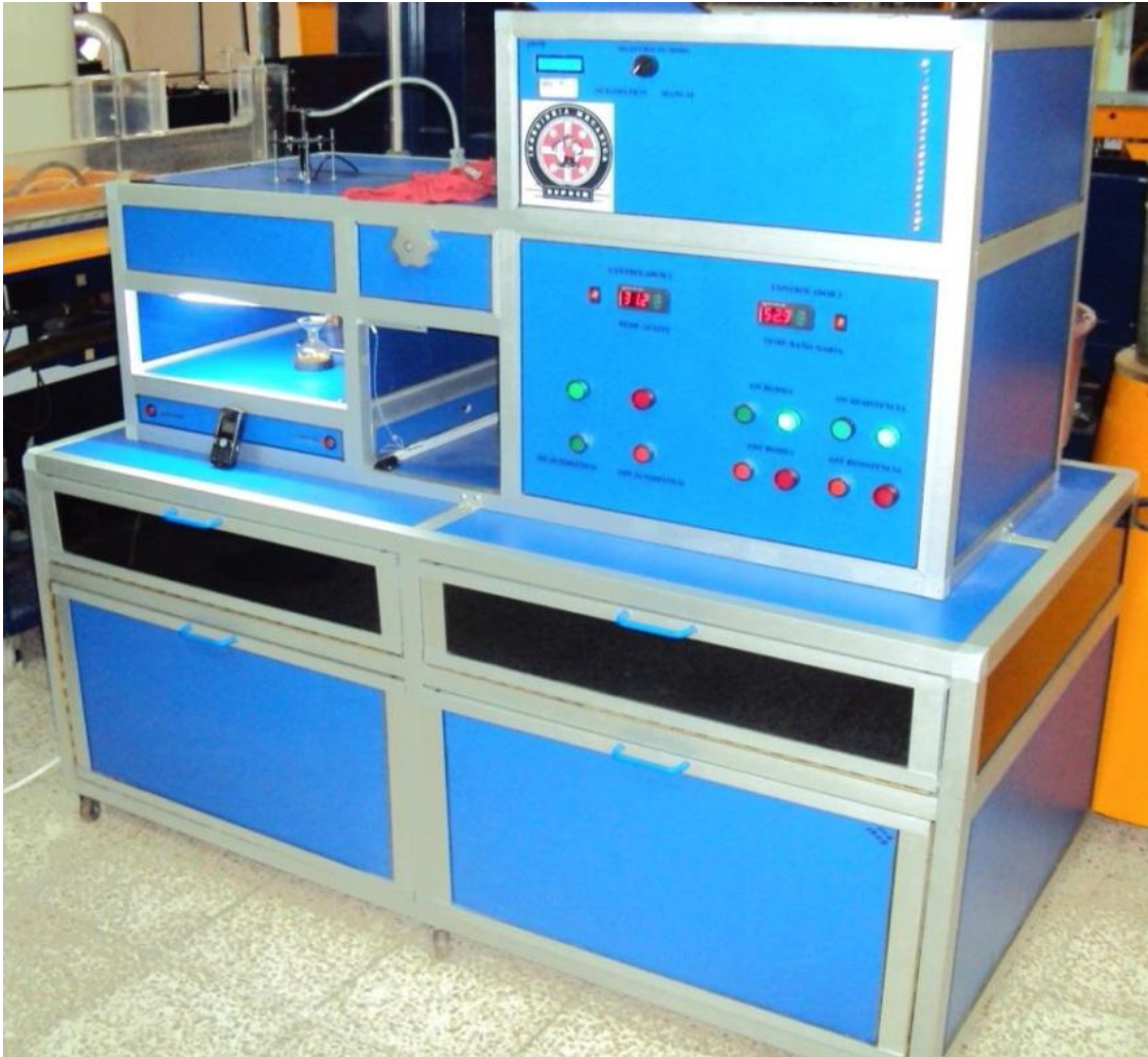
Figura 2.3. Banco de pruebas del viscosímetro de Saybolt
