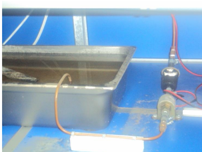
Figura 2.2. Elementos para el control del nivel de agua
