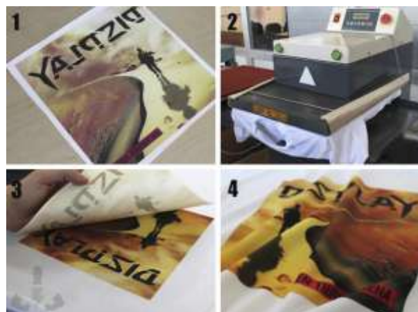
Figura 6 - 1 Proceso de sublimación textil
