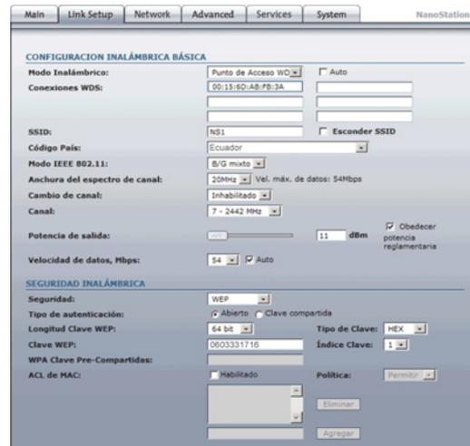
Figura: V.41: Configuración parámetros Antenas
