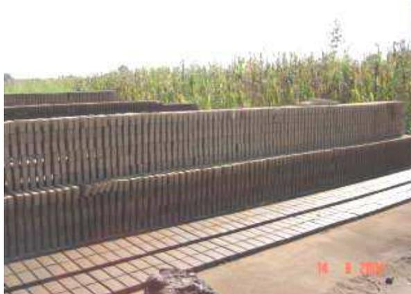
**Figura 2.6 Ladrillos moldeados con gaveras (sobre el suelo).**
