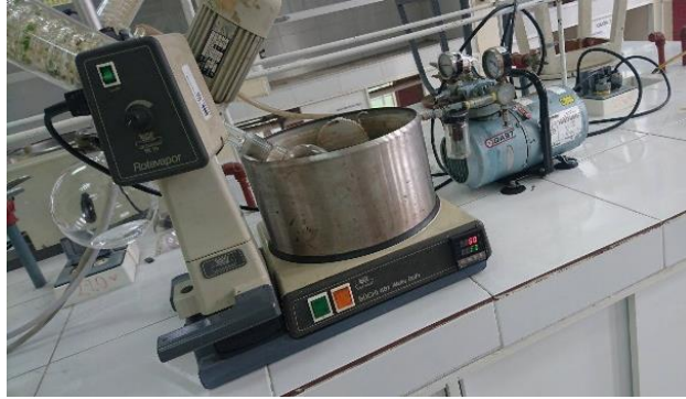
FOTOGRAFÍA 2B. Evaporación del solvente en rotavapor.
