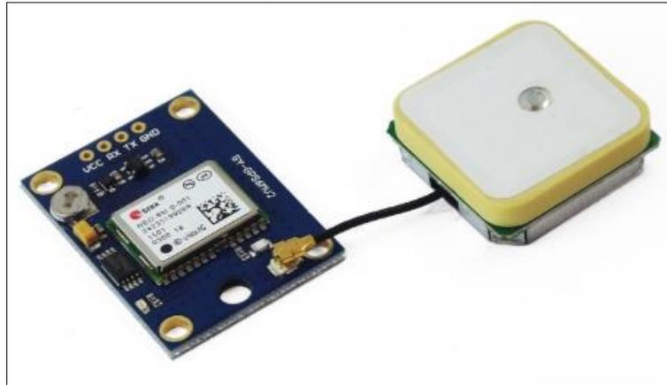
**Figura 16-2** Módulo GPS NEO-6M
