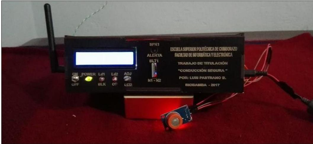
**Figura 7-3** Nodo 1 – Alcoholemia y Comunicación (Ensamblado)
