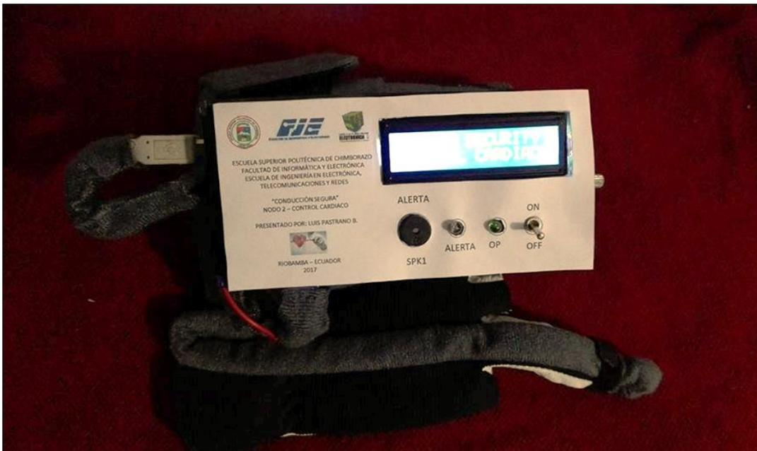
**Figura 8-3** Nodo 2 – Frecuencia Cardiaca (Ensamblado)
