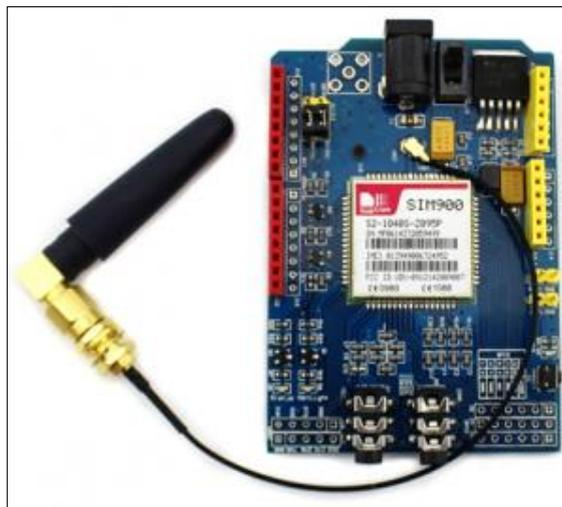
**Figura 11-2** Shield GSM/GPRS SIM900
