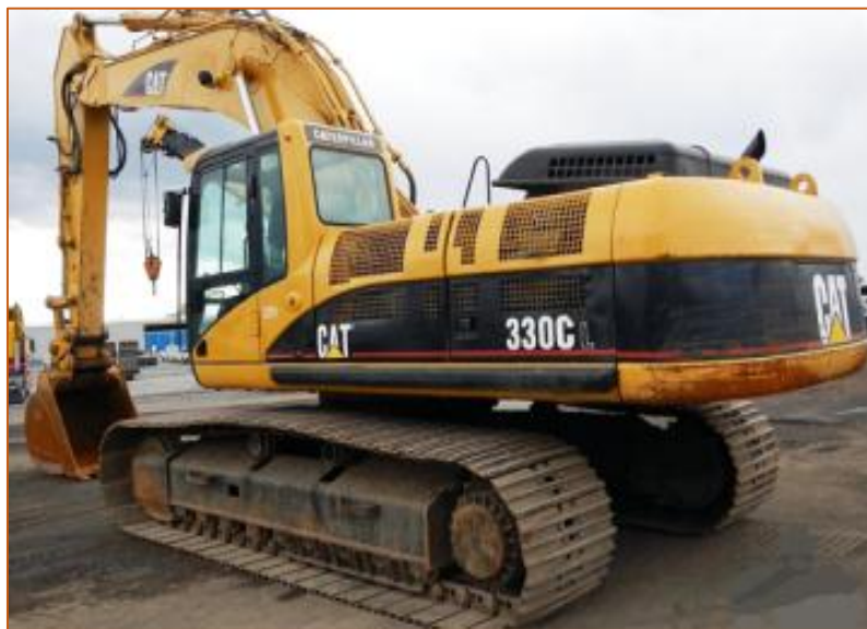
Ilustración 24: Excavadora sobre orugas 330CL
