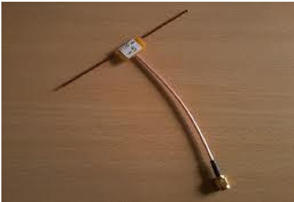
**Figura II.8** Antena Dipolo
