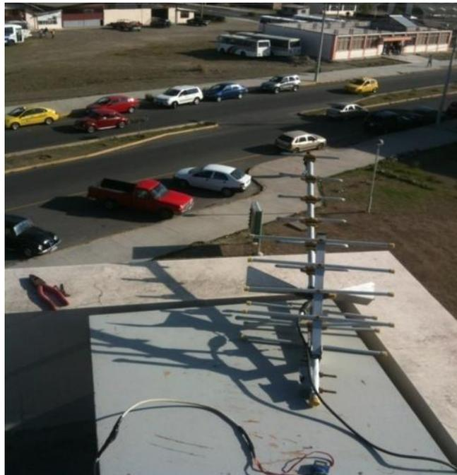
**Figura IV.37** Antena Yagi apuntamiento
