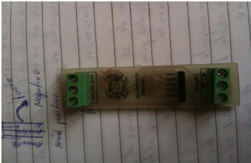
Placa para controlar el sensor mediante un microchip.
