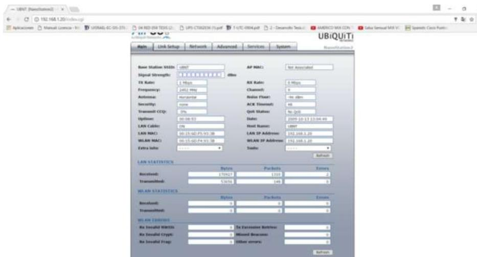
3.- Configurar la antena como Access Point y configurar sin seguridad inalámbrica para que los usuarios tengan acceso a la red.
