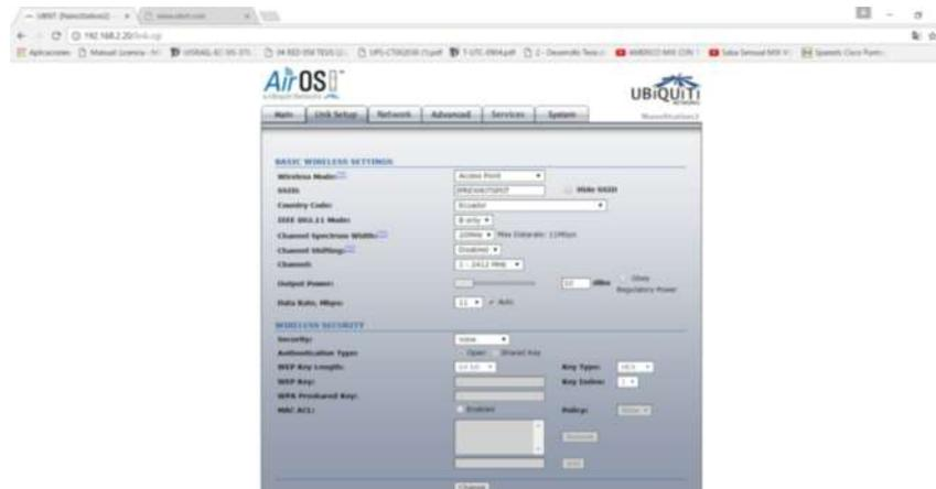
4.-Configurar Network y colocar en la opción Router lo cual permite que la antena pueda enviar la información de manera correcta hacia los usuarios.
