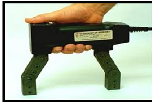
Figura 13. Máquinas portátiles (Yokes) para detectar discontinuidades superficiales y sub-superficiales en materiales ferro magnéticos.
