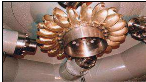
Figura 3. Turbina Pelton de eje horizontal, con cuatro equipos de inyección.
