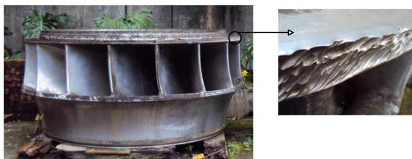
Figura 43. Evidencias de erosión y cavitación en el perfil del Rodete Francis (Central Agoyán)
