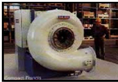
Figura 7. Cámara espiral de una turbina Francis.
