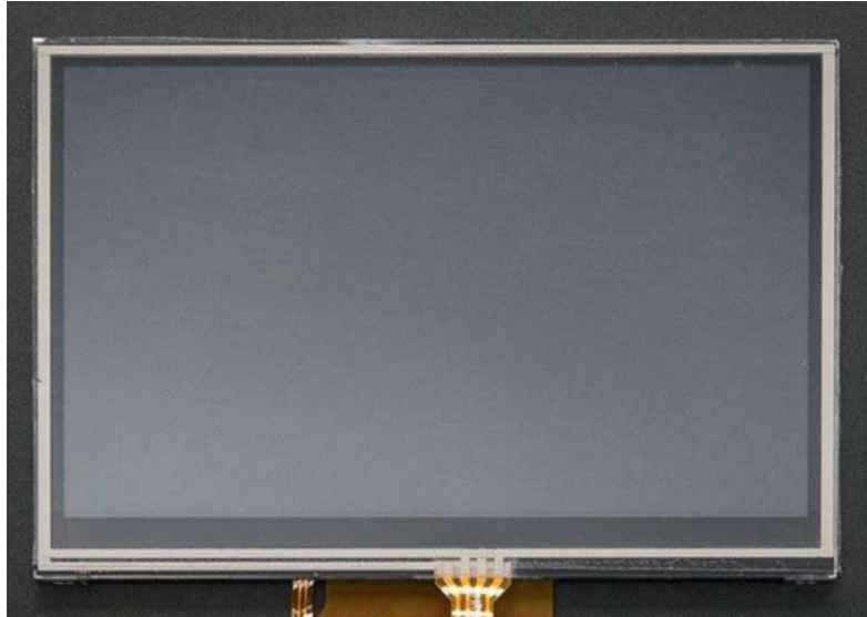
Figura 17-1: Pantalla de tipo TFT 4.3”
