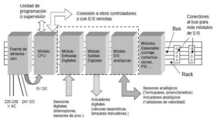
Figura 9-1: Arquitectura de un PLC
