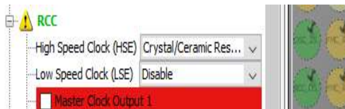
Figura 7-2: Configuración del oscilador STM32F746
