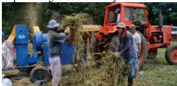
Figura 26. Máquina desgranadora de fréjol con conexión a un tractor
