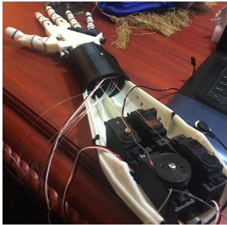
Figura 5-18: Montaje de servomotores y ajuste de cables.
