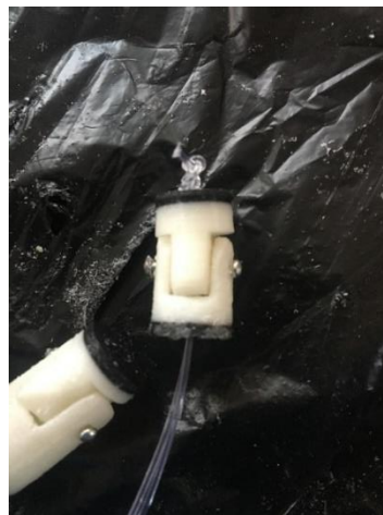
Figura 5-10: Cable a través de la parte superior del dedo.
