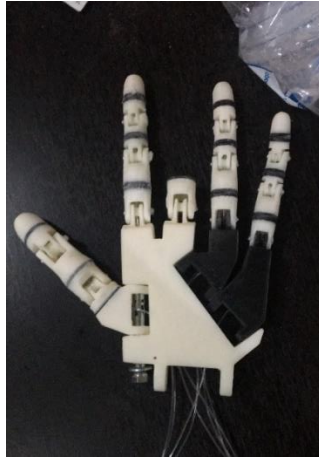
Figura 5-11: Ensamble y paso de cables por la mano.
