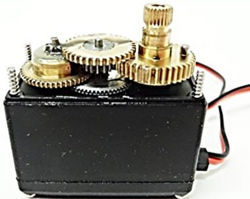
Figura 5-1. Engranajes metálicos del servo motor.
