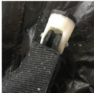
Figura 5-8: Unión de la base del dedo a la palma
