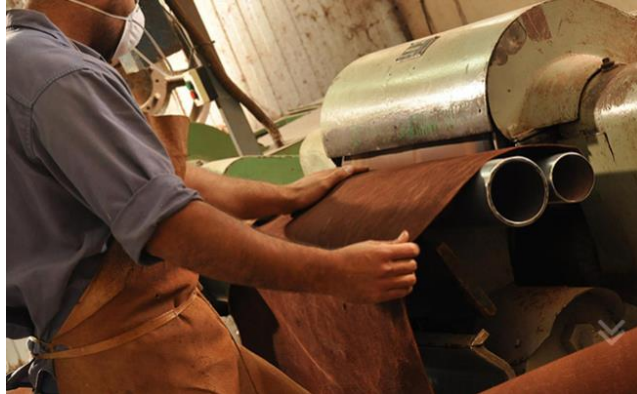
Figura 3-2: Operario Zúñiga Hnos. trabajando con máquina que puede sufrir atrapamiento de sus extremidades superiores.
