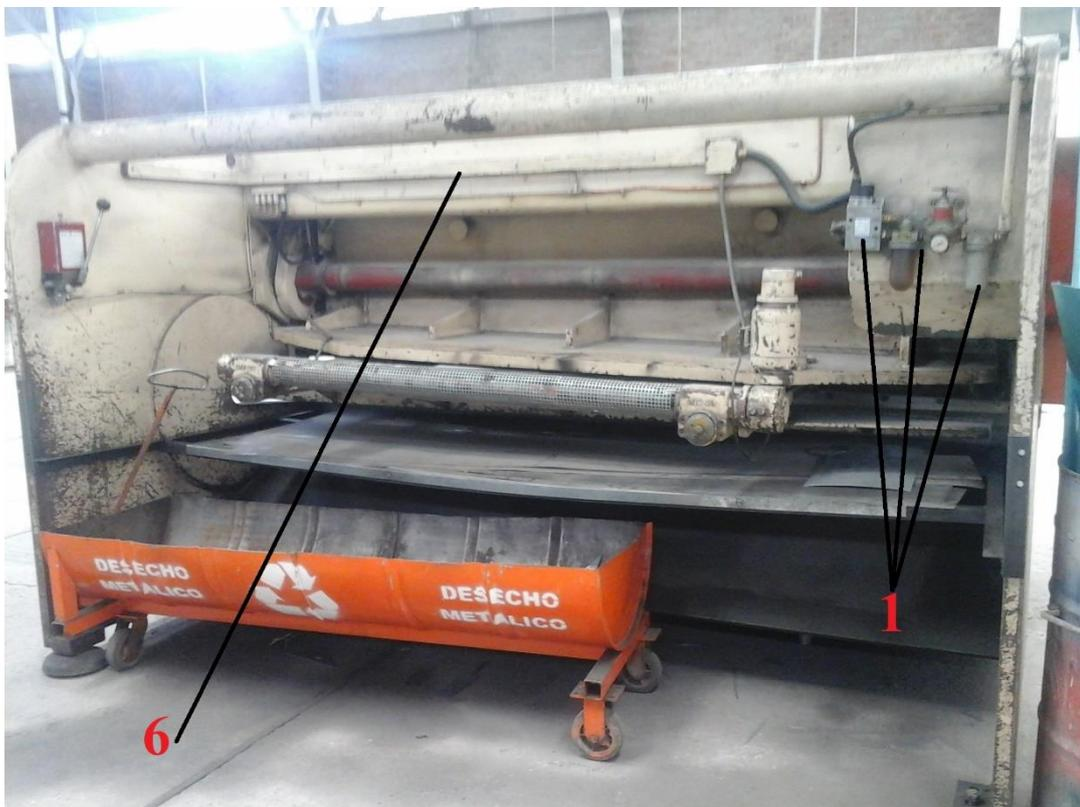
**Figura 26-3:** Foto de la parte posterior de la cizalla hidráulica.
