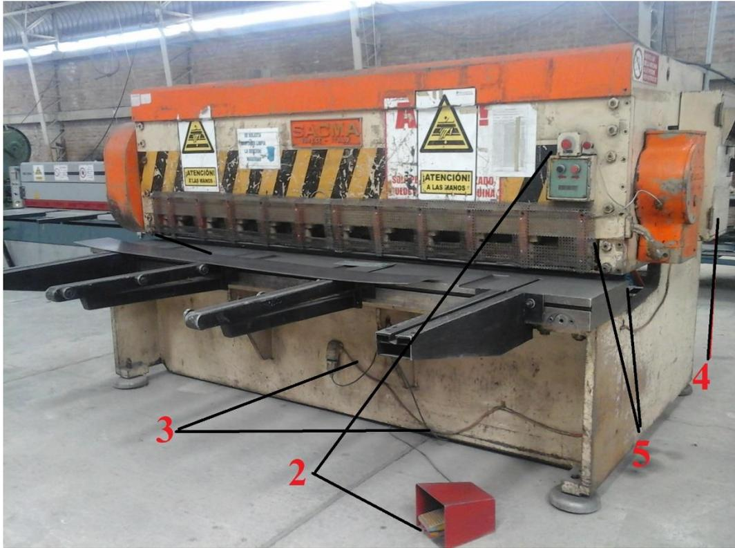
**Figura 25-3:** Foto de las partes delantera de la cizalla hidráulica.
