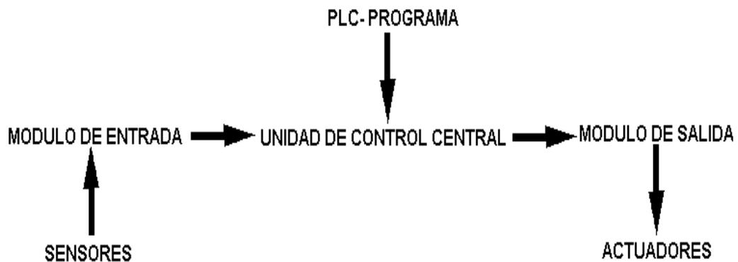
Dependiendo como esté conectada la unidad de control a los módulos de entrada y salida podemos tener PLC compactos (módulo de entrada, unidad de control central y módulo de salida en un solo cuerpo) o PLCs modulares.
