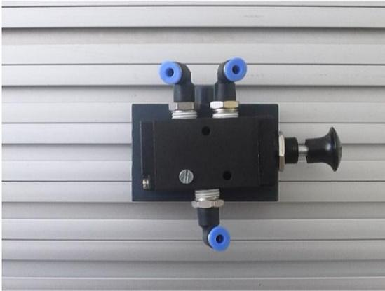
Figura VI. 75.- Válvula 5/2 con interruptor
