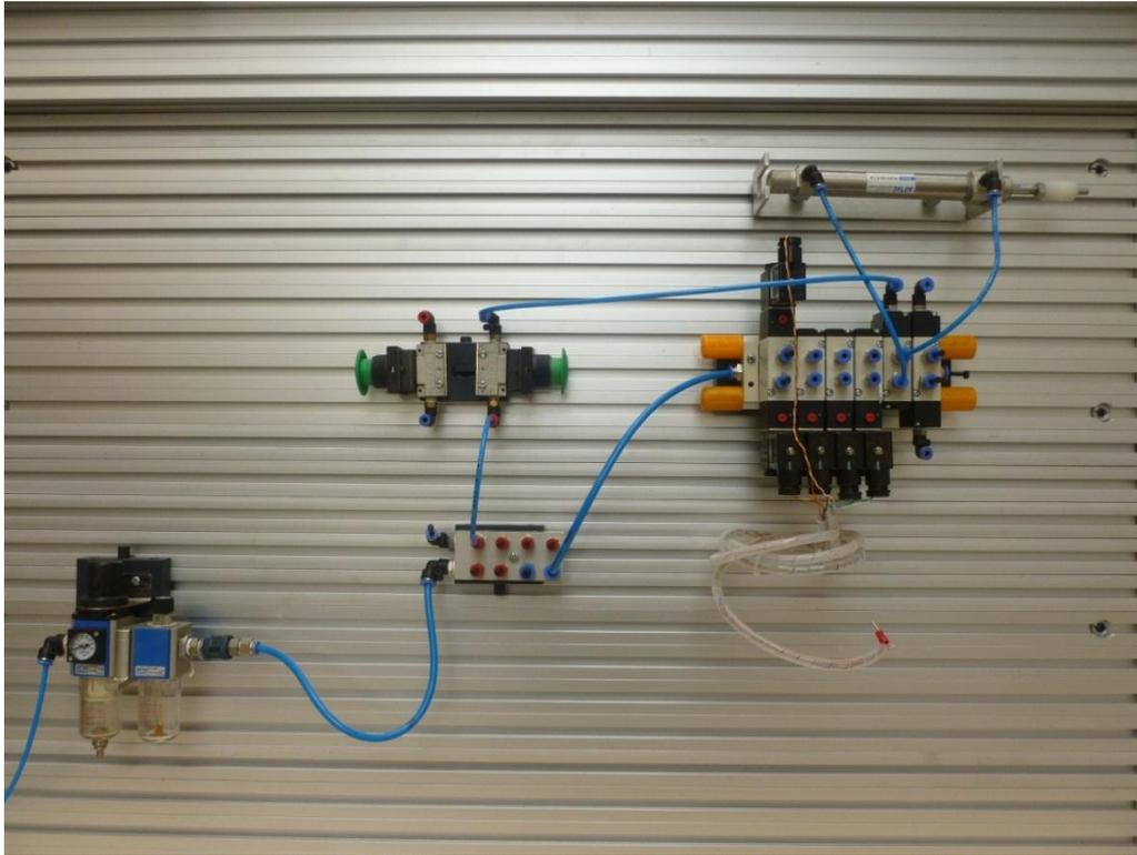
Figura VII. 103.- Montaje del circuito neumático (Práctica 1)
