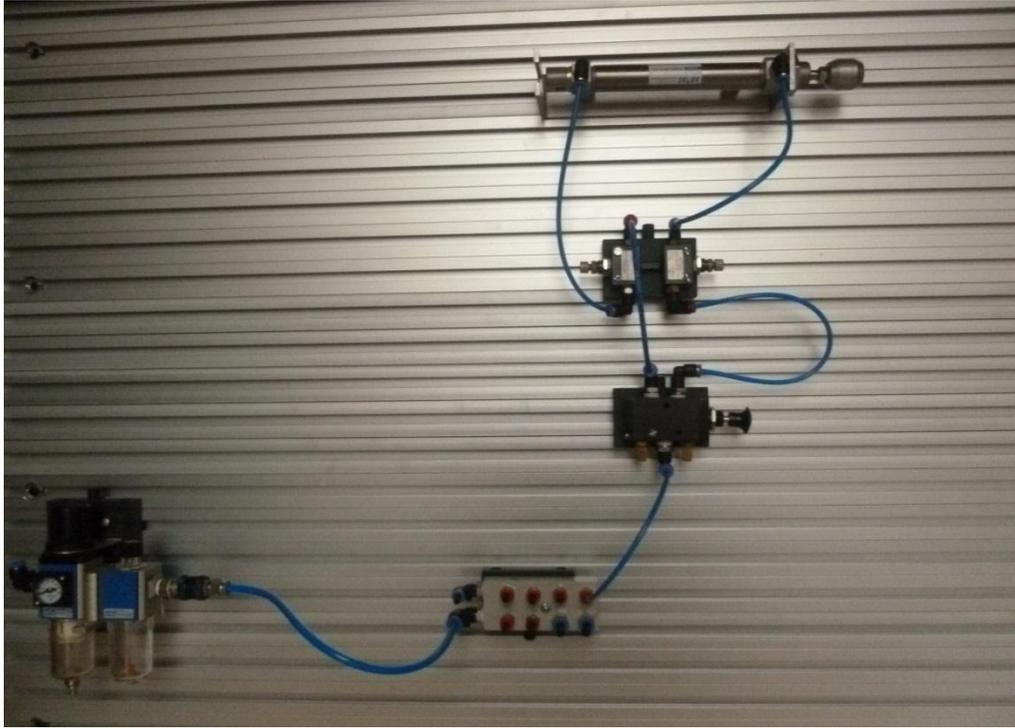
Figura VII. 105.- Montaje del circuito neumático (Práctica 2)
