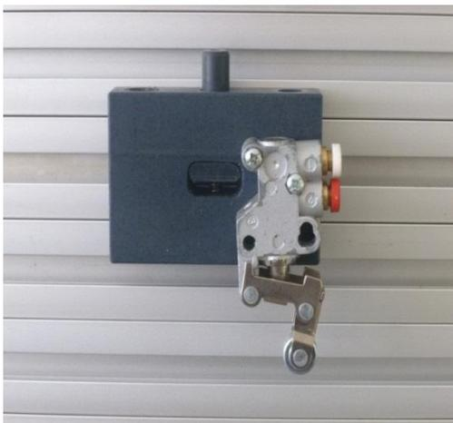
Figura VI. 76.- Válvula 3/2 accionada por rodillo
