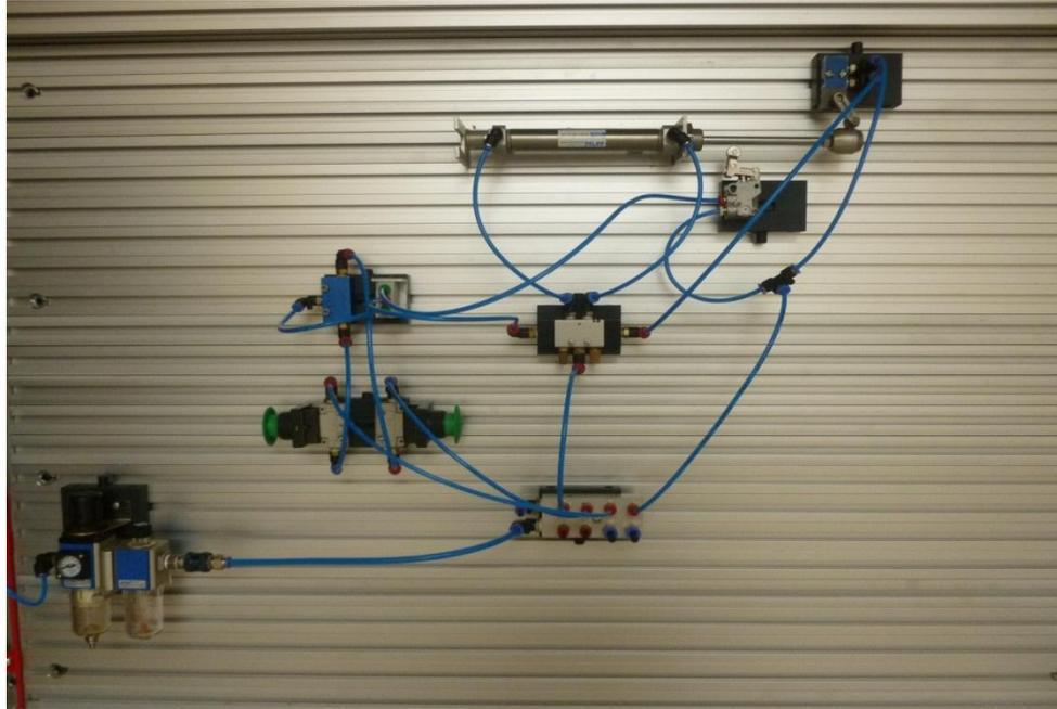
Figura VII. 117.- Montaje del circuito neumático (Práctica 8)
