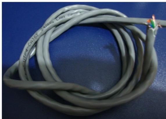
*Fig. III. 19 Cable UTP Multifilar*
