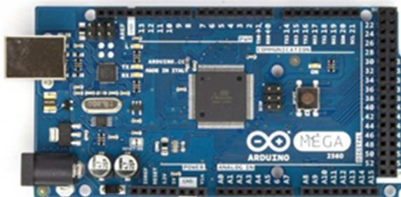
*Fig. II. 22 Arduino Mega 2560*
