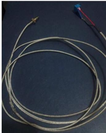
*Fig. II. 14 Termopar Tipo K*
