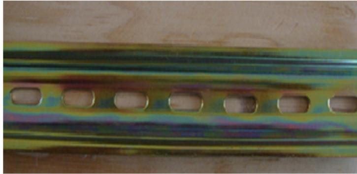
*Fig. III. 22 Riel DIN Tablero Arduino*
