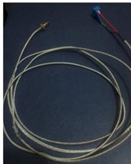
*Fig. III. 27 Termopar Tipo K*
