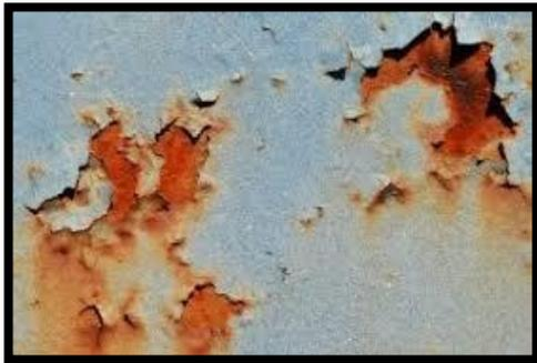
a) Corrosión sobre el metal
