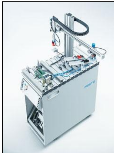
Figura 2.3: Estación de manipulación Fuente: (Festo, MPS 500-FMS, 2017)
