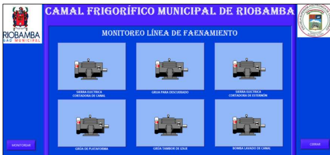
Figura 1-3: Pantalla de monitoreo de cargas todas apagadas
