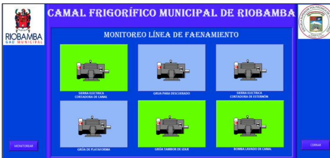
Figura 3-3: Pantalla de monitoreo del proceso con cargas activas alternadas
