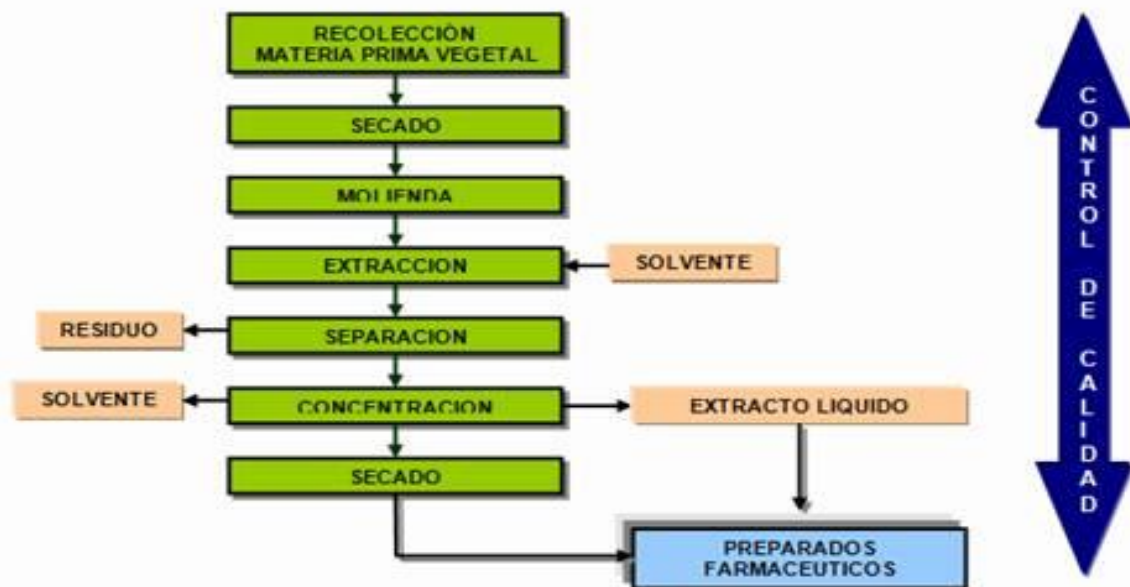
FIGURA 2. PROCESO DE OBTENCIÓN DE EXTRACTOS A PARTIR DE PLANTAS MEDICINALES
