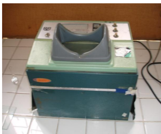
FOTOGRAFÍA No. 10 IDENTIFICACIÓN DEL PRINCIPIO ACTIVO MEDIANTE CÁMARA UV
