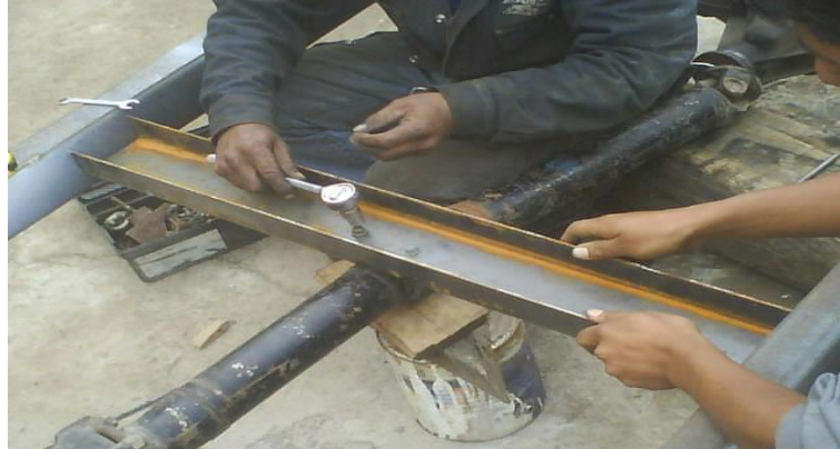
Figura 5.11. Montaje del árbol de transmisión al travesaño
