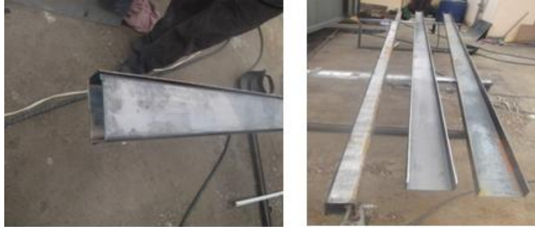
Figura 5.1. Traslape del perfil en C
