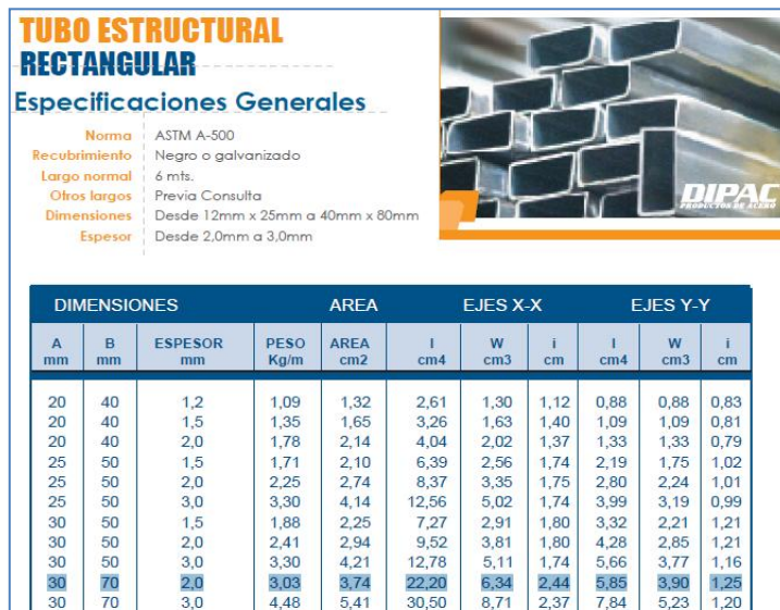
Figura 2.28. Especificaciones generales tubo rectangular
