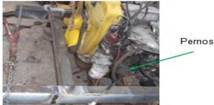
Figura 5.9. Montaje del motor
