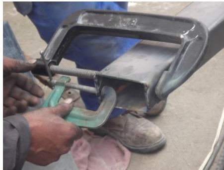
Figura 5.2. Fijación del perfil para el traslape
