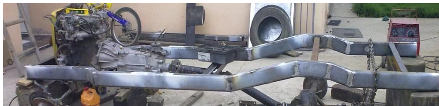
Figura 5. 8. Esmerilado de aristas vivas del bastidor
