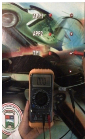
Figura 68. Verificación del sensor TP1 desconectado.
