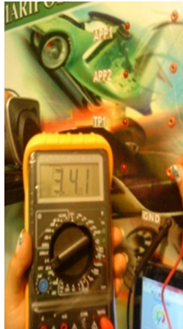
Figura 96. Verificación del voltaje de retorno del sensor TP2 del sistema.
