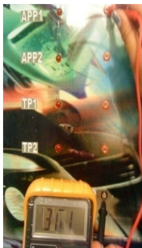
Figura 100. Verificación del voltaje de retorno del sensor APP1 del sistema.
