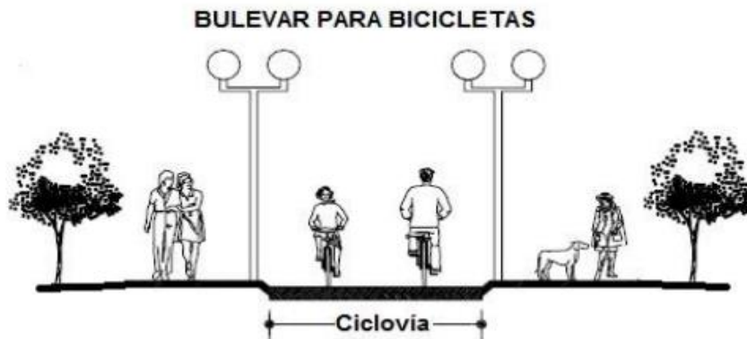
Imagen 8: Esquema vertical, cicloruta doble sentido en calle peatonal Fuente: Plan Maestro de Ciclorutas, Colombia 2004
