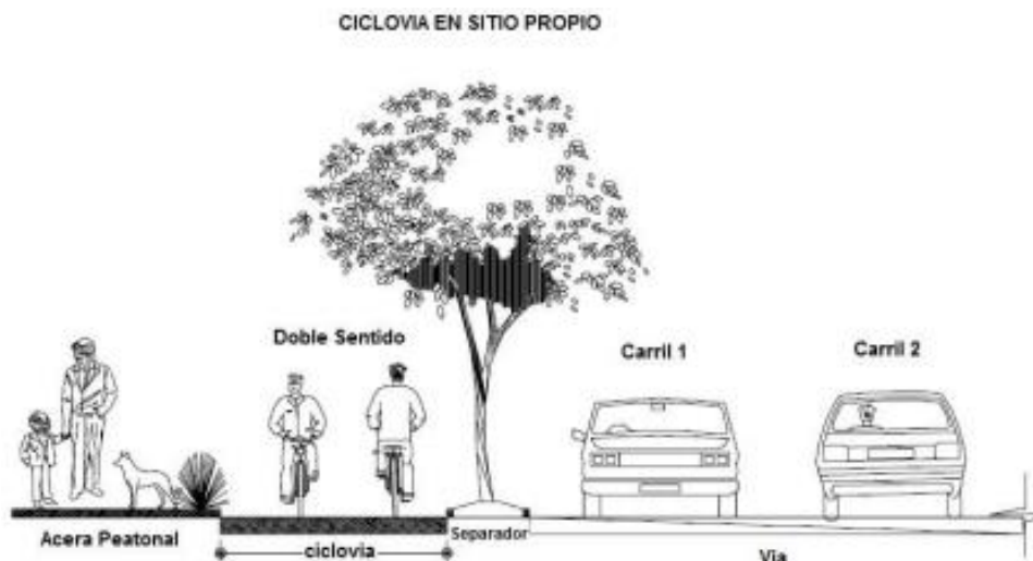
Imagen 4: Esquema vertical cicloruta doble sentido sitio propio Fuente: Plan Maestro de Ciclorutas, Colombia 2004
