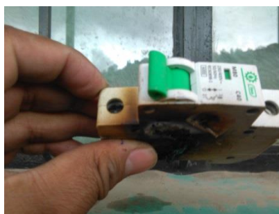
Figura 20: Térmico dañado Fuente: Investigación propia Elaborado por: Wilson Gualotuña.
