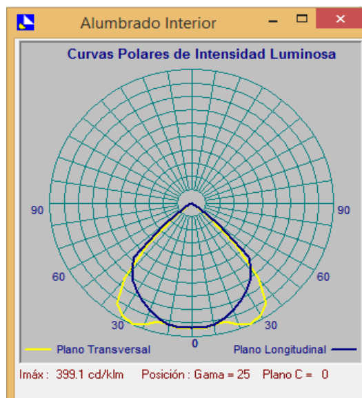
Figura 20. Curvas polares de Intensidad luminosa para las luminarias Gerencia.
