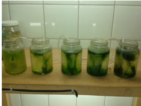
Figura 2 - Cultivo da microalga em frascos de vidro de 500 mL em diferentes concentrações do meio BBM
