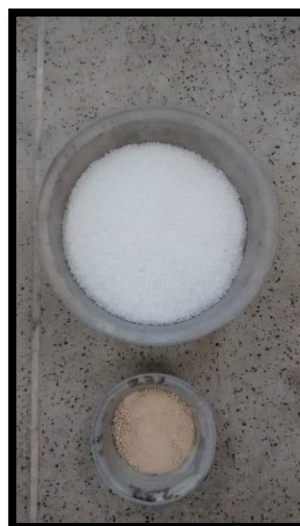
Ilustración 16. Equivalencia de Material Granular sustituido por Poliéstireno Expandido.
