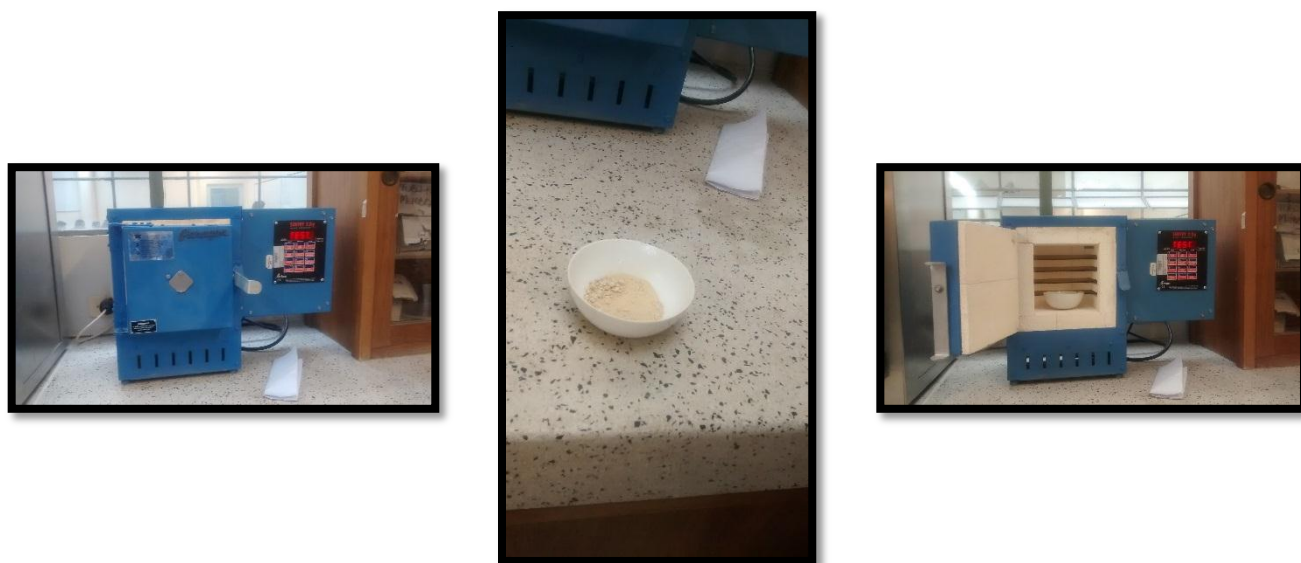
Ilustración 14: Registro Fotográfico Ensayo Contenido Material Orgánico – Desarrollo Propio.
