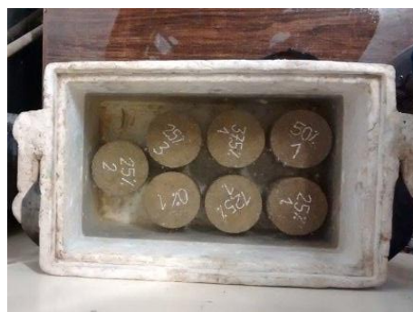
Ilustración 47: Humedecimiento y Secado de briquetas de Suelo-Cemento – Ciclos de curado y Exposición a Temperatura – Desarrollo Propio.
