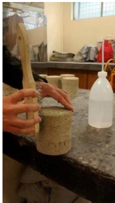
Ilustración 48: Humedecimiento y Secado de briquetas de Suelo-Cemento – Raspado de Briquetas – Desarrollo Propio.
