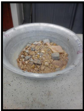
Ilustración 7: Registro Fotoaráfico Ensayo Granulometría – Desarrollo Propio.
