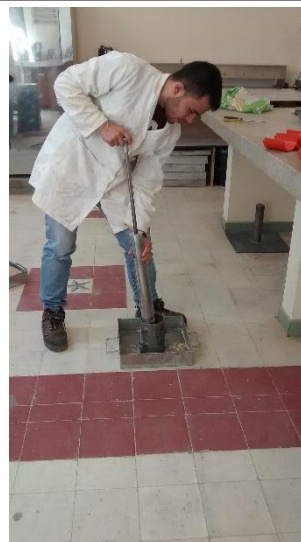
Ilustración 17: Relación Humedad-Densidad Mezclas de Suelo-Cemento – Desarrollo Propio.
