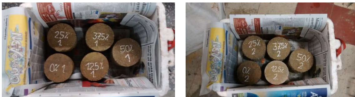
Ilustración 46: Humedecimiento y Secado de briquetas de Suelo-Cemento – Proceso de Cámara Húmeda
