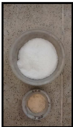
Ilustración 16. Equivalencia de Material Granular sustituido por Poliéstireno Expandido.
