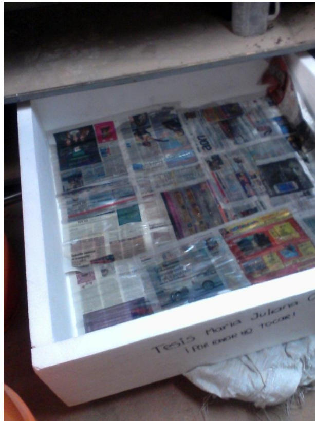
Figura 9: Cámara húmeda fabricada cubierta con papel humedecido Fuente: Autor.
