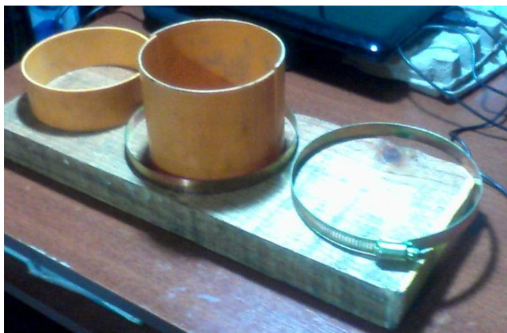
Figura 5: Base de madera y abrazadera para cada molde Fuente: Autor
