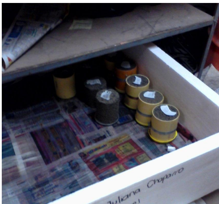
Figura 8: cámara de curado utilizada en la investigación Fuente: Autor
