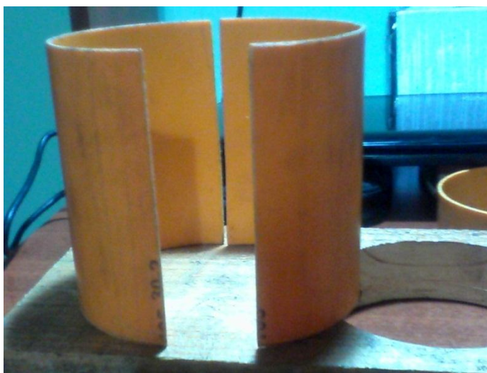
Figura 4. Molde fabricado a partir de una tubería de PVC de diámetro de 4".
