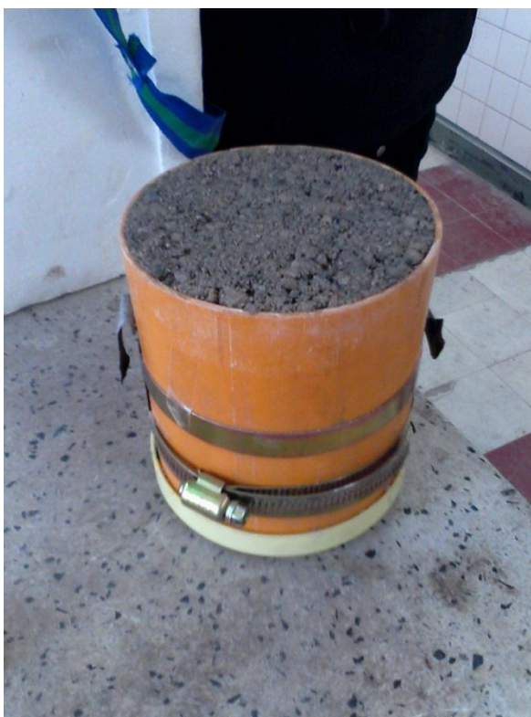
Figura 7: Probeta elaborada en el molde diseñado con la energía de compactación propuesta en la Norma I.N.V. E -612 - 13 numeral 6.2
