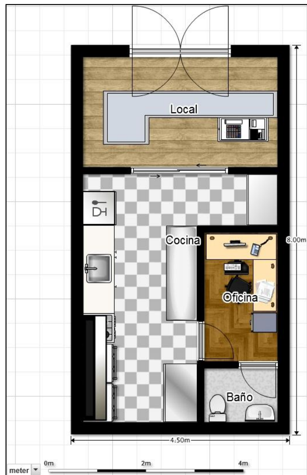
Ilustración 21. Distribución de la Instalación / Plano
