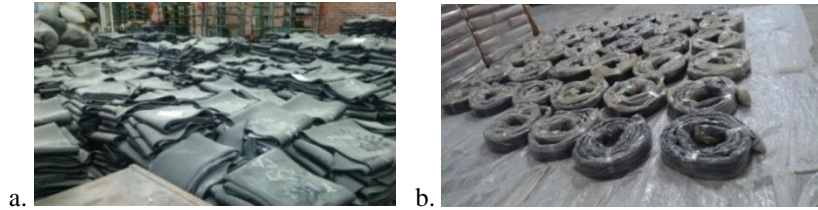
Figura 1. Productos fabricados en la planta de producción de Creaciones Medellín LTDA. Nota: a. Compuesto de caucho b. Tiras de caucho preformadas. Fuente: Tomadas por el Autor.
