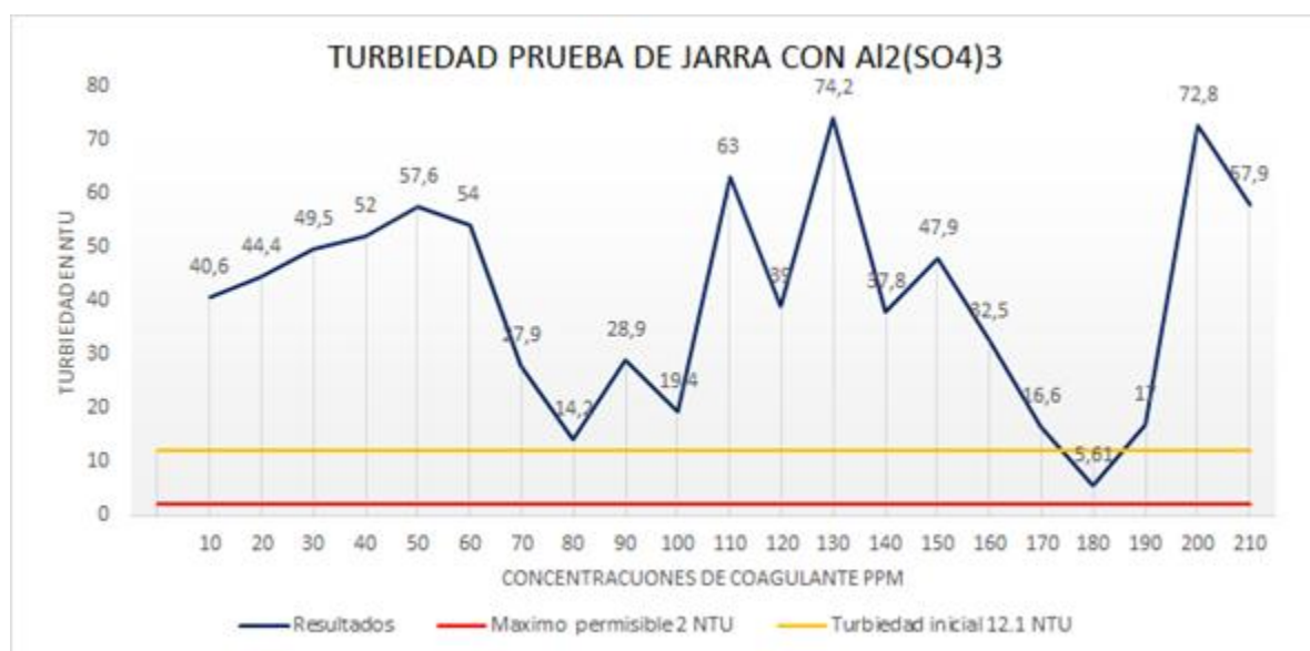
Gráfica 1. Resultado de Turbiedad de ensayo de jarras con coagulante de sulfato de aluminio. Comparado con los máximos permisibles y turbiedad inicial
