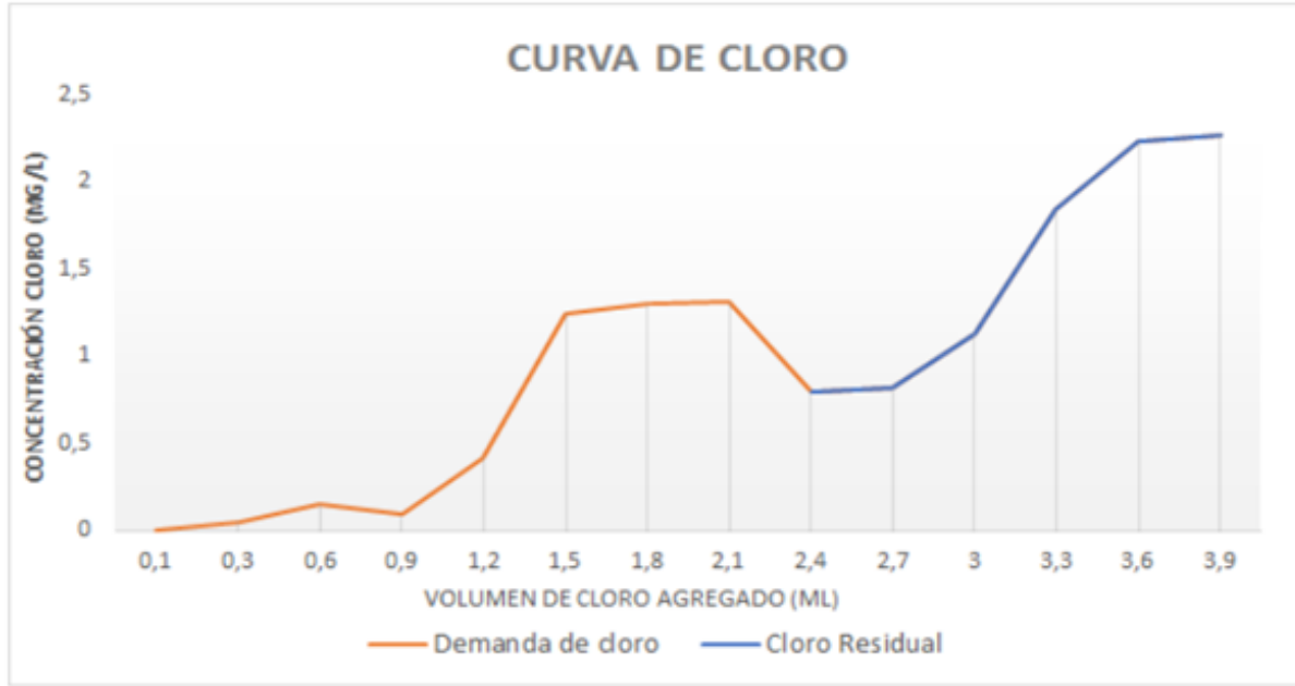
Grafica 4. Demanda de cloro, por medio de una curva de cloración midiendo cloro necesario, y cloro residual libre para el proceso de desinfección
