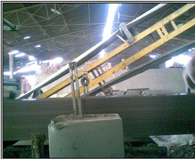
Fotografía 20. Etapa de Corte del Ladrillo crudo.
