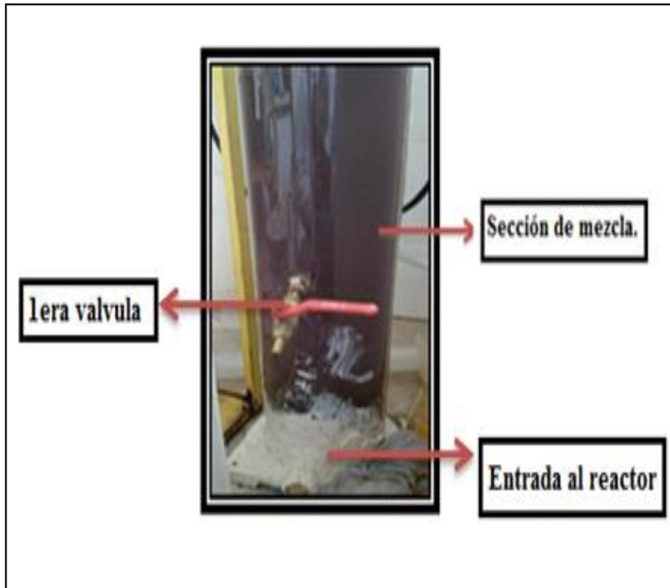
Figura 15. Sección 1 o de alimentación al reactor
