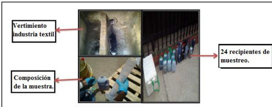
Figura 13. Muestreo compuesto de agua residual en la industria textil
