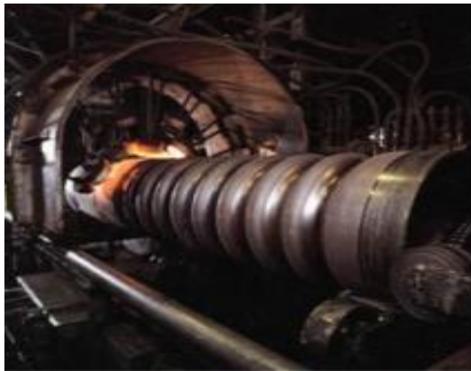
Figura N° 7 Hogar Ondulado para Calderas Piro tubulares
