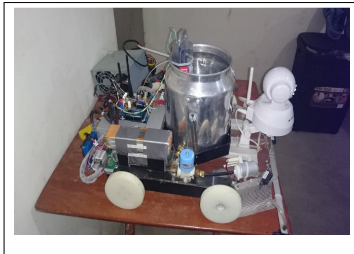
Figura. 33 Implementación de robot semiautónomo fumigador de cultivos terminada de perfil
