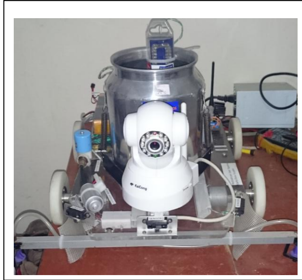
Figura. 32 Implementación de robot semiautónomo fumigador de cultivos terminada
