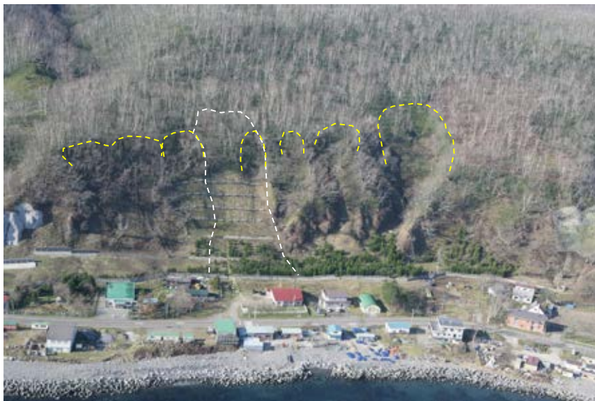
写真11 知床半島羅臼海岸町周辺の被災前の斜面地形(釧路建設管理部 2006年撮影) 2016年崩壊範囲(白破線)周辺にスプーンでえぐられたような地形(黄破線)が見られる.
