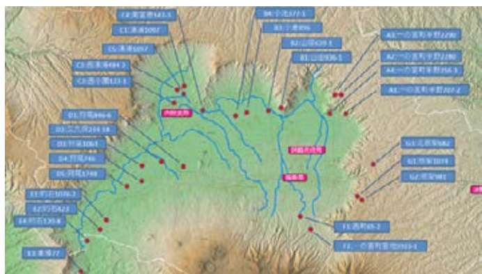
図1 中小河川流域ごとに設置した簡易水位計
