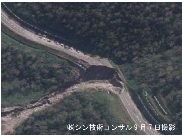
写真7 日勝峠の十勝側7合目崩壊の垂直写真 マサ状の斜面堆積物が崩壊・浸食
