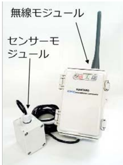
図 1 MEMS 傾斜計の例 (中央開発株) Fig. 1 Example of a MEMS tilt meter.
