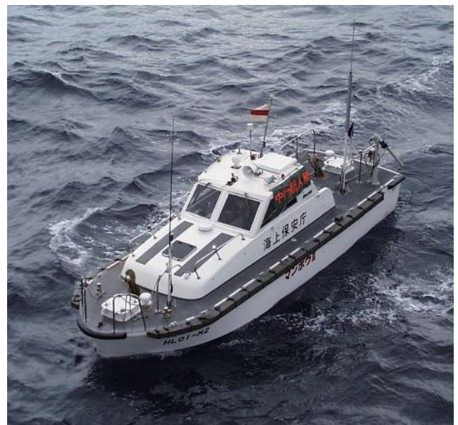
図4 有人/無人調査船「マンボウII」。普段は大型測量船に搭載されており、母船の接近できない海域における調査を行う。
