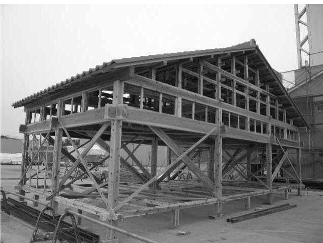
図2.2.33 L試験体の外観 (荒壁パネルなし)
