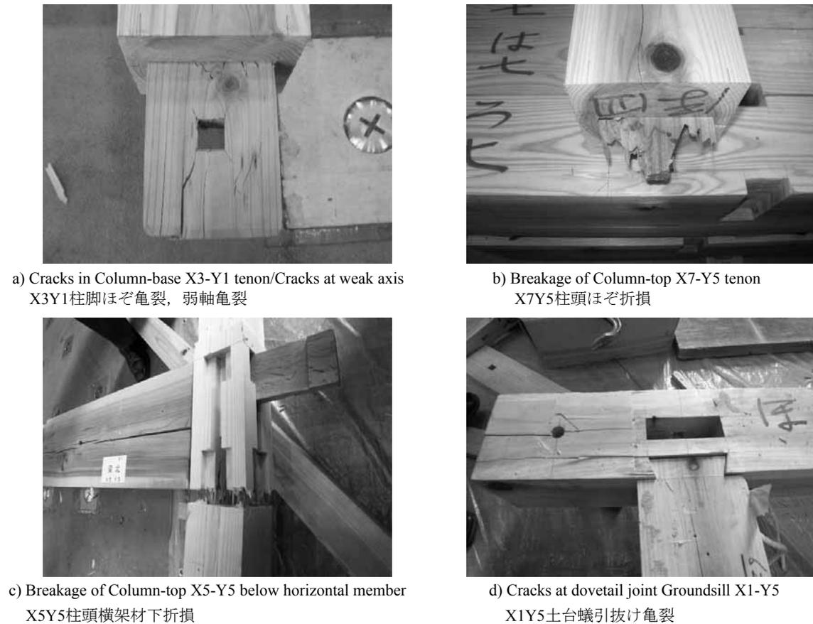
図2.4.51 DM (土台半剛床)試験体の解体時損傷
