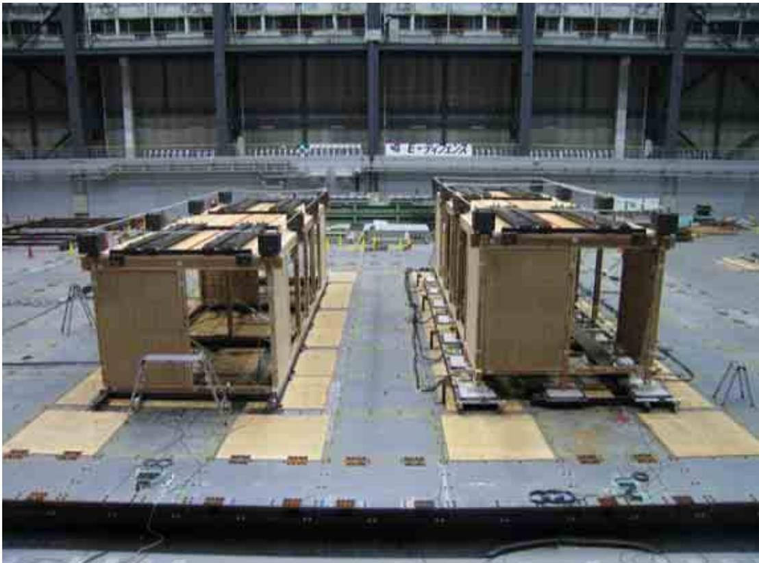
図 A-6 伝統構法建物実験 剛床試験体 加振前
