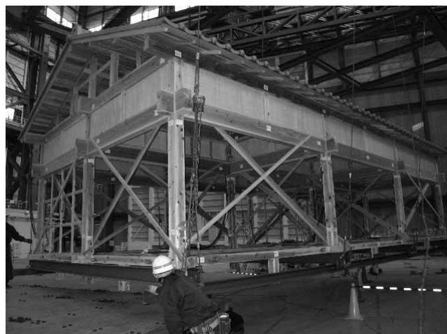
図2.3.4 屋根付き試験体の吊り上げ
