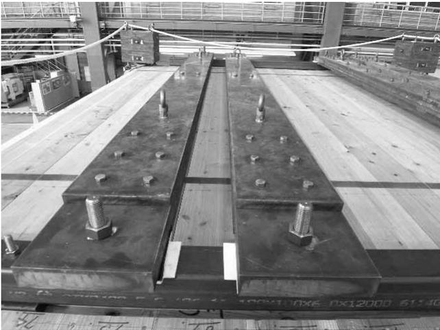
図2.2.15 平鋼錘の設置状況
