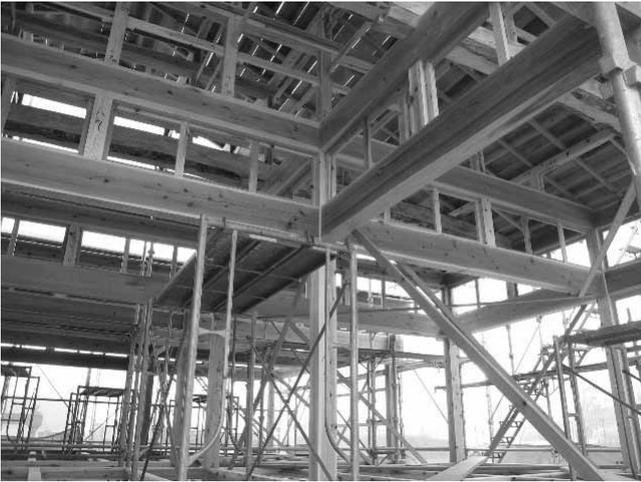
図2.2.29 L試験体の軸組 (荒壁パネルなし)
