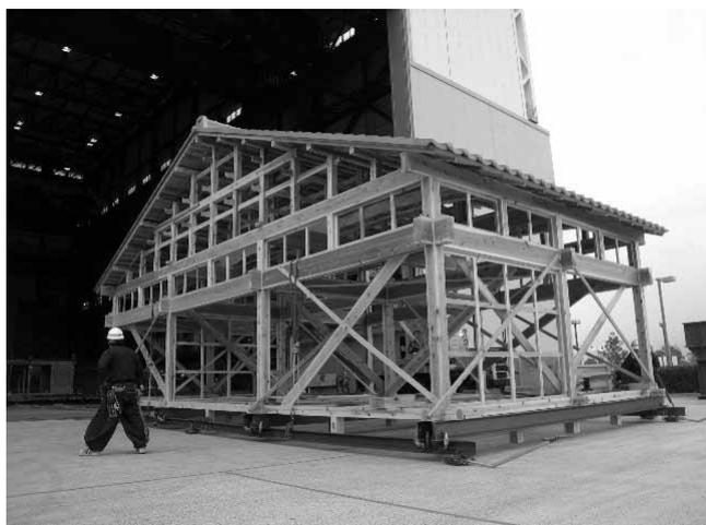
図2.3.3 屋根付き試験体の移動
