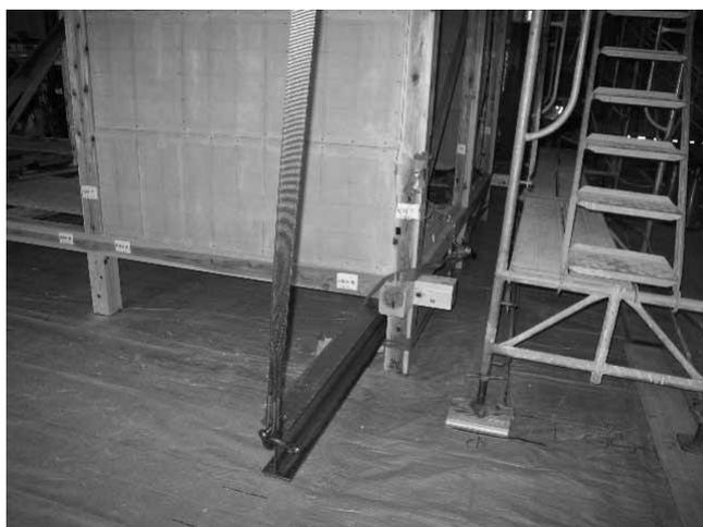
図2.3.1 標準試験体の吊り上げ治具
