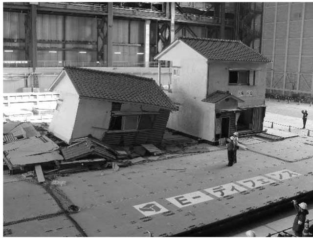
**図3.1.1** 平成17年度移築補強・無補強試験体 (左:A棟, 右:B棟)
