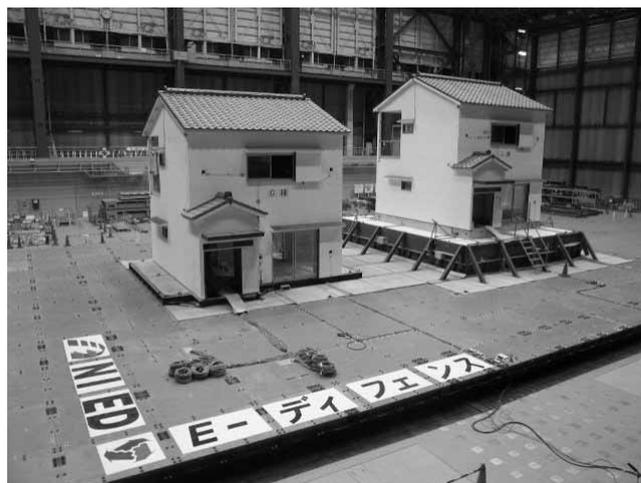
図1.1 在来構法建物実験 (左側C棟, 右型D棟)
