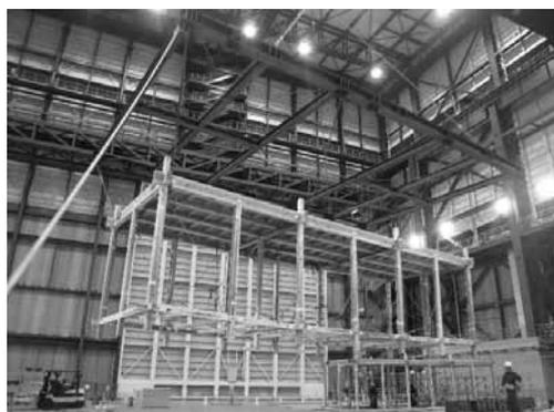
図2.4.33 標準試験体の撤去
