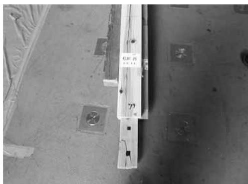
図2.4.35 部材ラベルと損傷箇所
