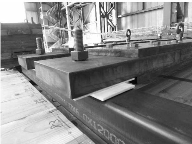
図2.2.17 平鋼錘下のテフロン設置状況
