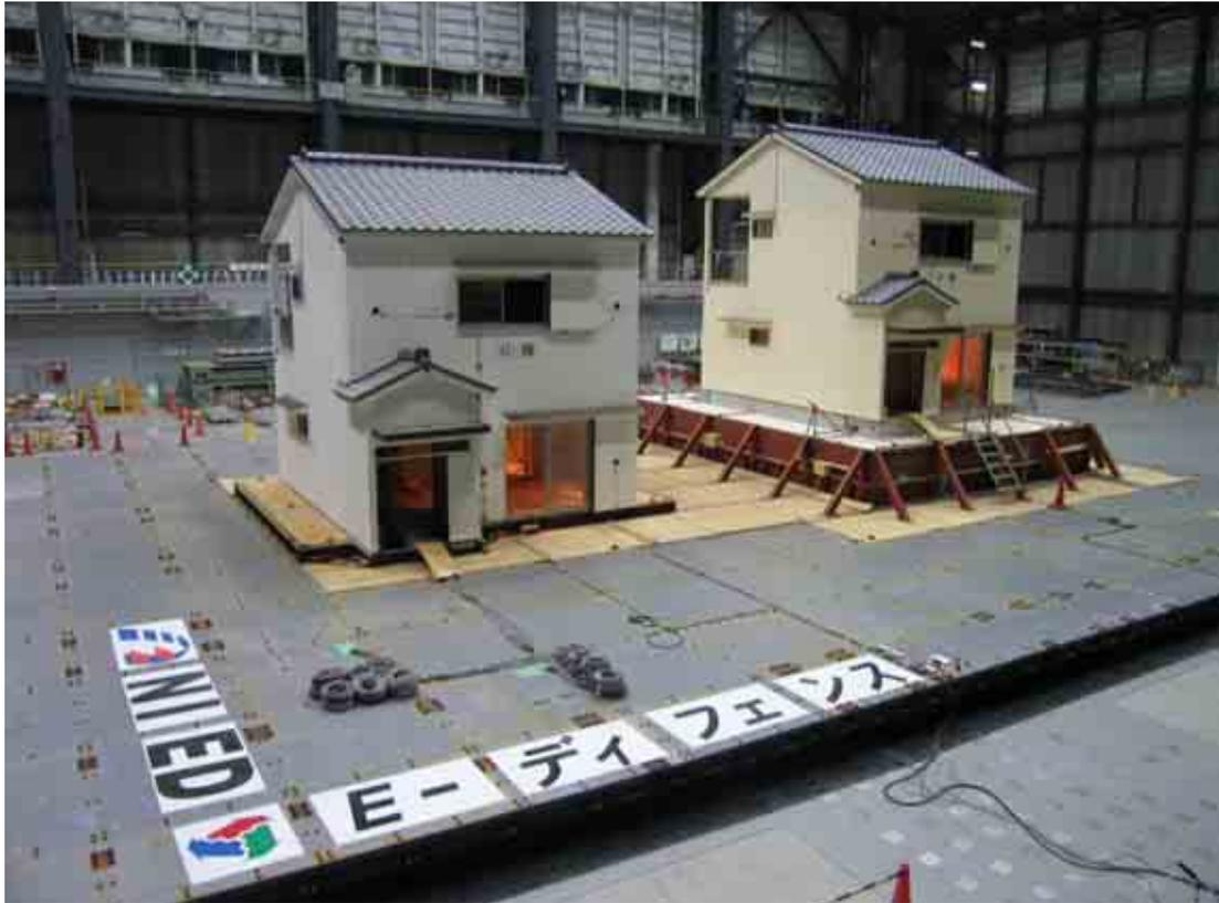
図 A-1 在来構法建物実験 加振前
