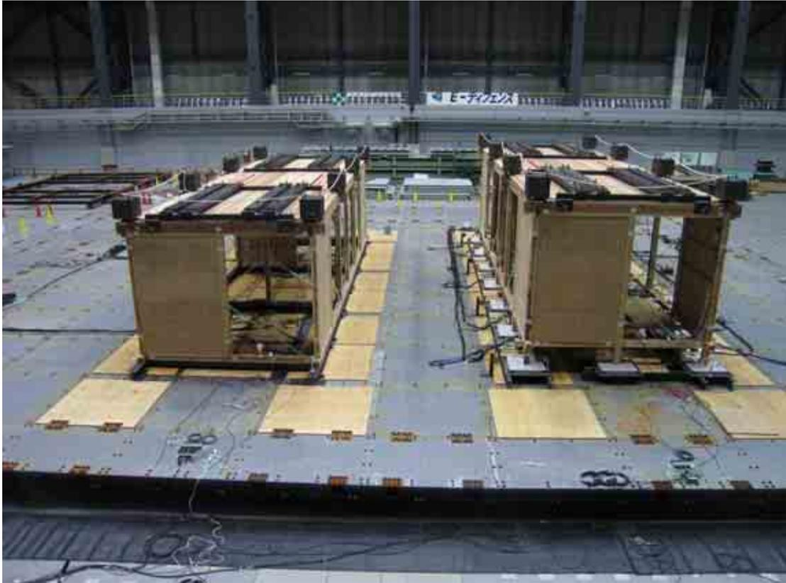
図 A-5 伝統構法建物実験 半剛床試験体 加振前
