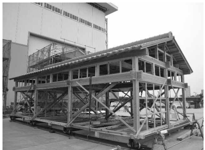
図2.2.34 S試験体の外観 (荒壁パネルなし)
