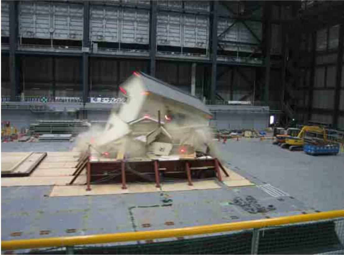
図 A-3 在来構法建物実験 倒壊
