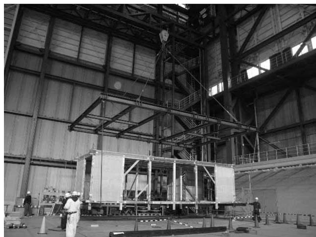
図2.3.2 標準試験体の吊り上げ
