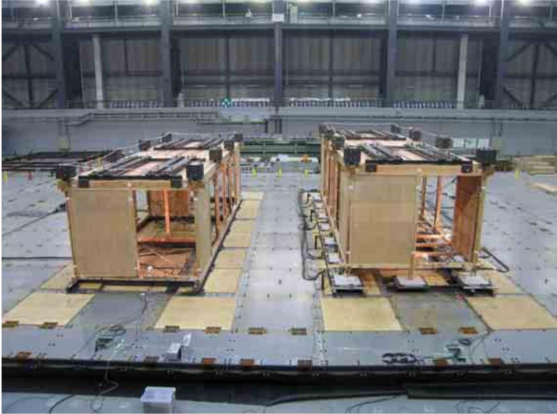
図 A-7 伝統構法物実験 柔床試験体 加振前
