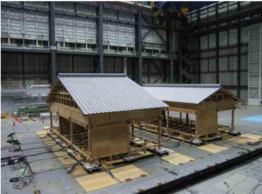
図 A-8 伝統構法建物実験 屋根付き試験体 加振前
