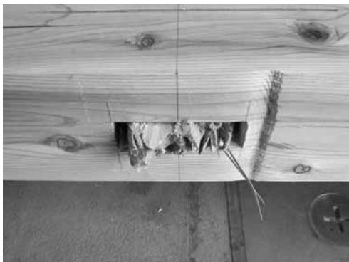
a) Breakage of Strut X1-Y5-6 tenon.
