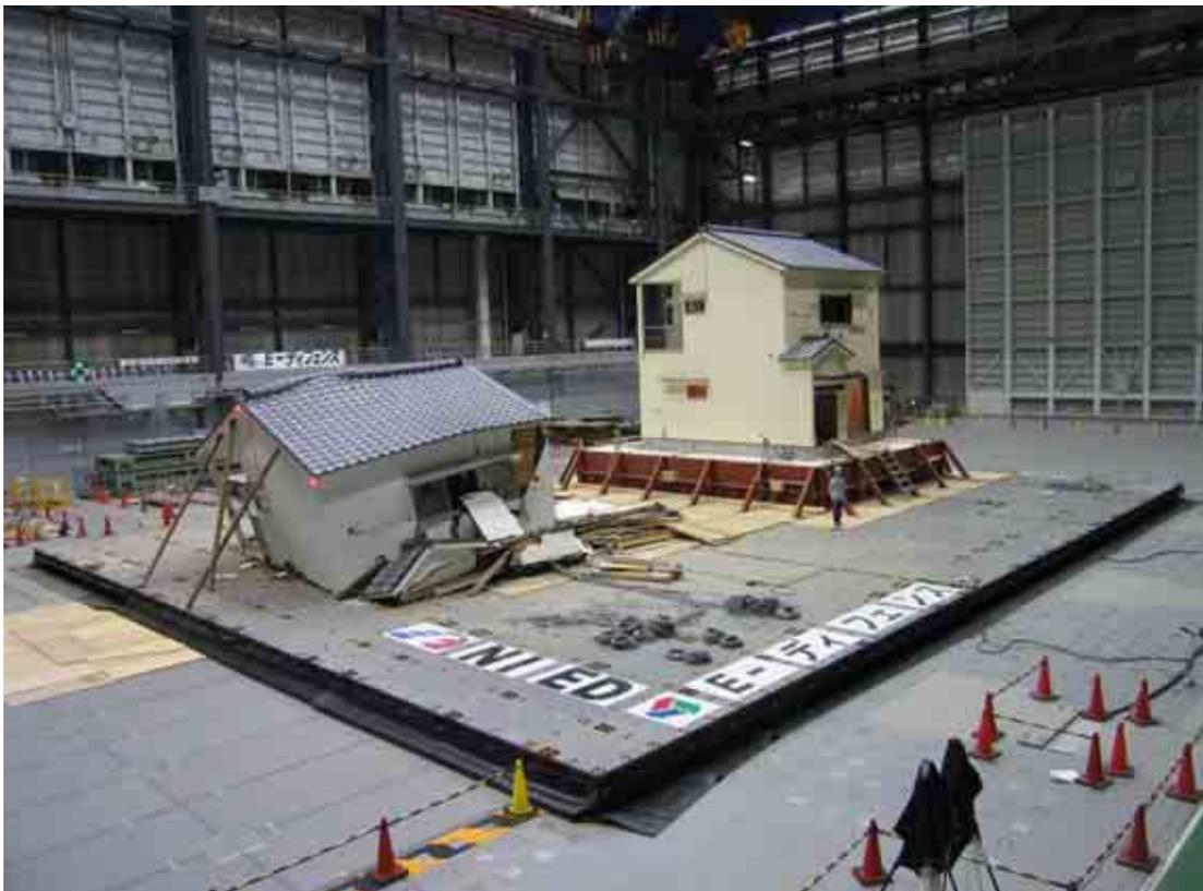
図 A-2 在来構法建物実験 倒壊後
