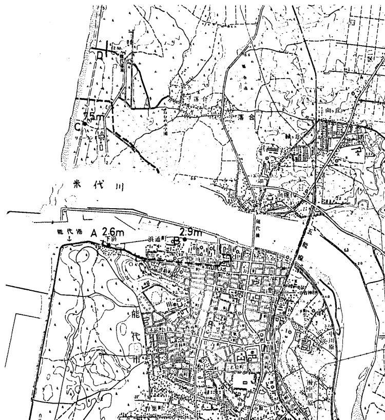
図 5.19 能代市街の浸水域(破線), 能代市災害対策本部 5 月 30 日発表による。A, B, C は第一回調査による津波高測定点。D は第二回調査による調査点。
