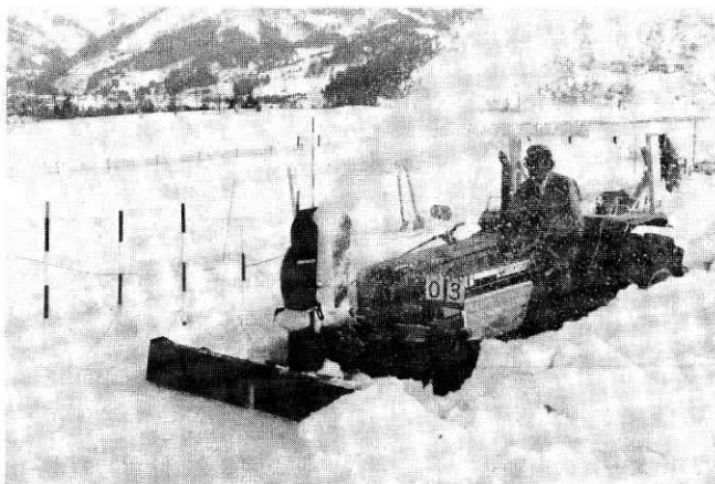
写真 5 除雪試験。 Photo. 5 Snow removing test.
