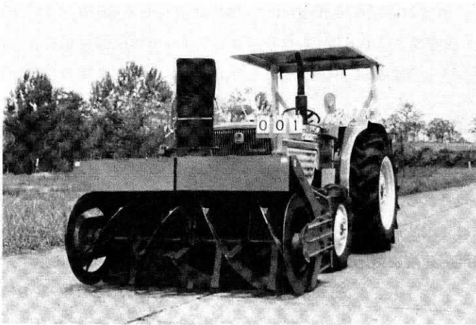
写真 3.1 試験用ロータリ除雪車の正面 (傾角 60^\circ オーガ装着).
