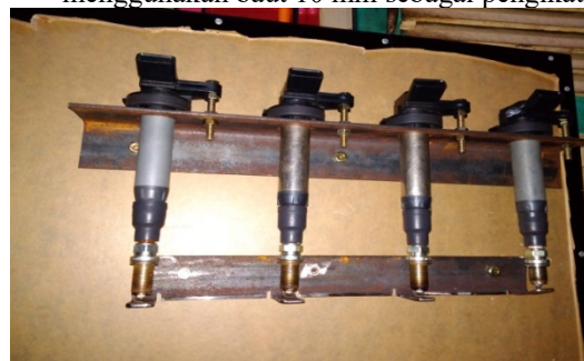
Gambar 5. Pemasangan Coil Dan Busi
