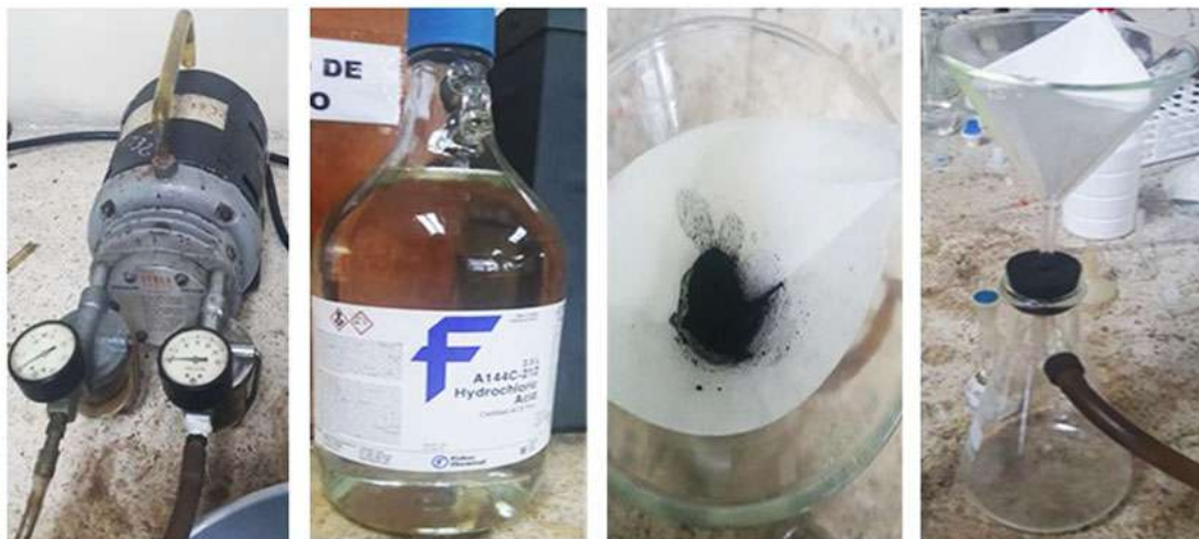
Figura 6. Materiales y equipos requeridos para la purificación de la muestra de G-O.
