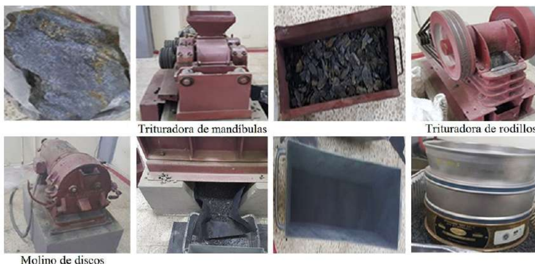
Figura 2. Materiales y equipos requeridos en el proceso de molienda y tamizado de esquistos de grafito.
