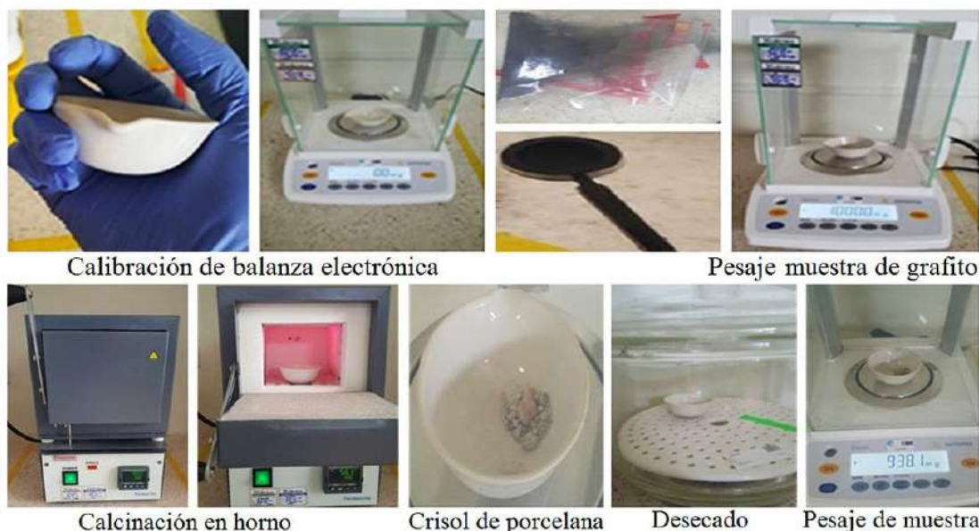
Figura 4. Materiales y equipos requeridos en las diferentes etapas del proceso de calcinación de grafito para determinar la cantidad de carbono presente.
