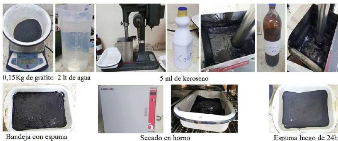
Figura 3. Materiales y equipos requeridos en el proceso de flotación de minerales.
