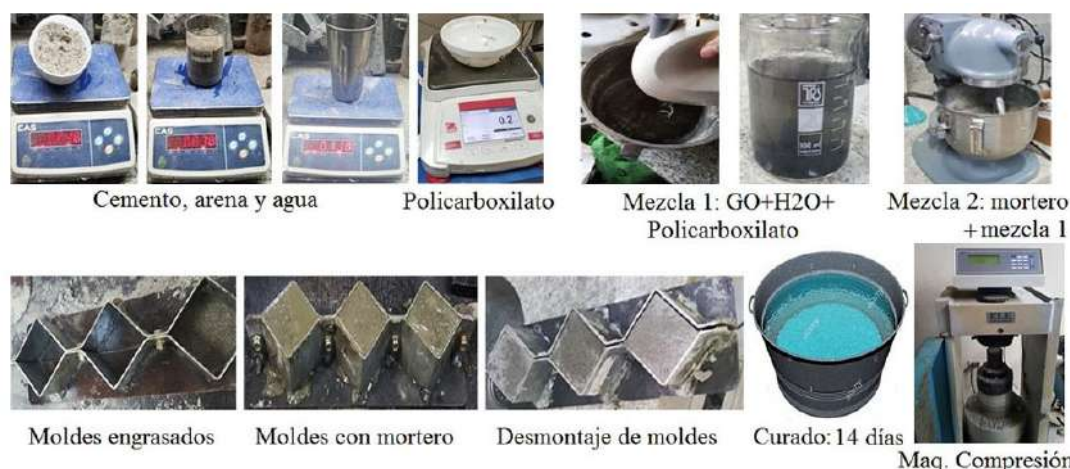
Figura 7. Etapas de preparación de muestras cúbicas de mortero reforzado con G-O y rG-O para ensayo a compresión.
