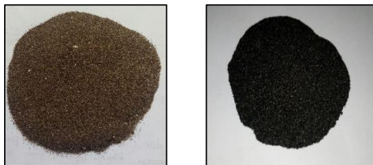
Gambar 1. Pasir besi sebelum diproses (kiri) dan sesudah diproses (kanan)
