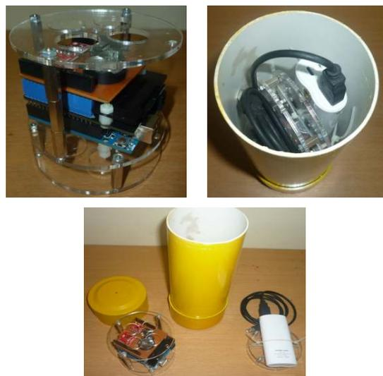
Gambar 6. Hasil Perancangan Peralatan Unit Pemantau Perekam Data
