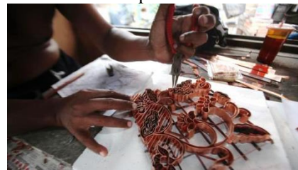
Gambar 12 Proses Pembuatan Cetakan Batik Cap
