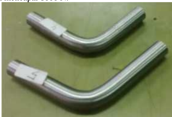
Gambar 11. Bahan uji las gesek dengan beban bengkok
