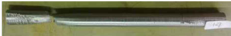
Gambar 9. Patahan hasil uji kekuatan tarik
