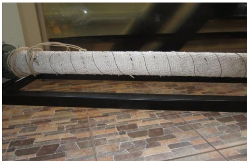
Gambar 10. Heater berfungsi untuk memanaskan udara sebagai media pemanas Dryer
