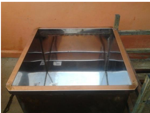
Gambar 3. Bak Pencampur Adonan Krupuk Hasil rancangan Tim Pengabdian, terbuat dari plat stainless steel kualitas-1, kapasitas 50 kg/proses
