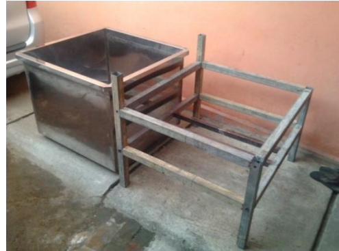
Gambar 4. Bak Pencampur Adonan Krupuk Hasil dan Kerangka Besi untuk Penopang
