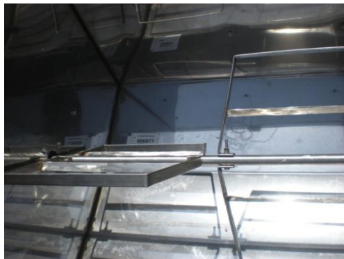
Gambar 6. Impeller yang Dipasangkan pada As Pengaduk agar Proses Pencampuran Adonan menjadi Lebih Merata
