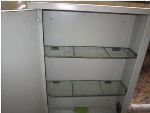
Gambar 8. Kamar atau Kabin Pengering ( Dryer ) yang telah dilengkapi dengan tray
