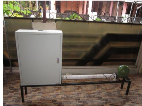
Gambar 11. Satu Set Prototipe Alat Pengering tipe Tray untuk Pengeringan Irisan Adonan Krupuk
