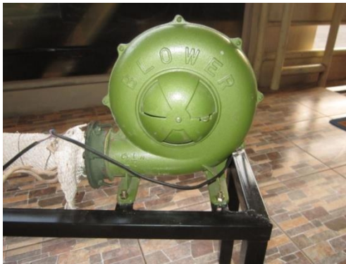
Gambar 9. Blower berfungsi untuk membawa atau menghembuskan udara panas untuk didistribusikan ke dalam kabin pengering ( Dryer )
