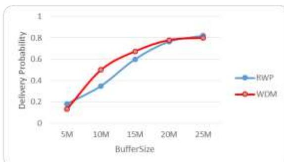
Gambar 6. Hasil pengujian delivery probability terhadap perubahan BufferSize
