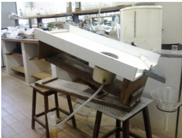
Figura 3. Rampa para o ensaio de Inderbitzen(Foto: Silva, 2014)
