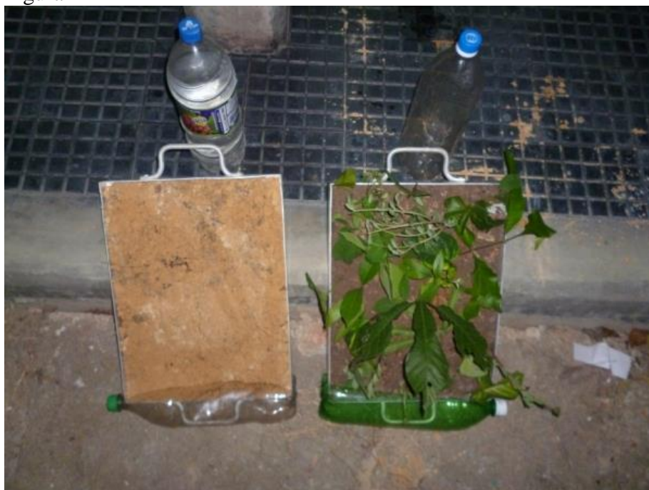
Simulação didática do processo erosivo em solo com e sem vegetação. Fonte: Verona (2012).
